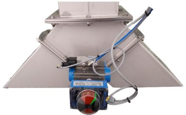
Fördelningsventil med pneumatiskt vriddon
