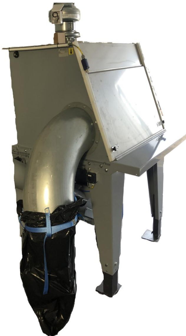
Kondel med fluidisering och anslutning för nivågivare.
